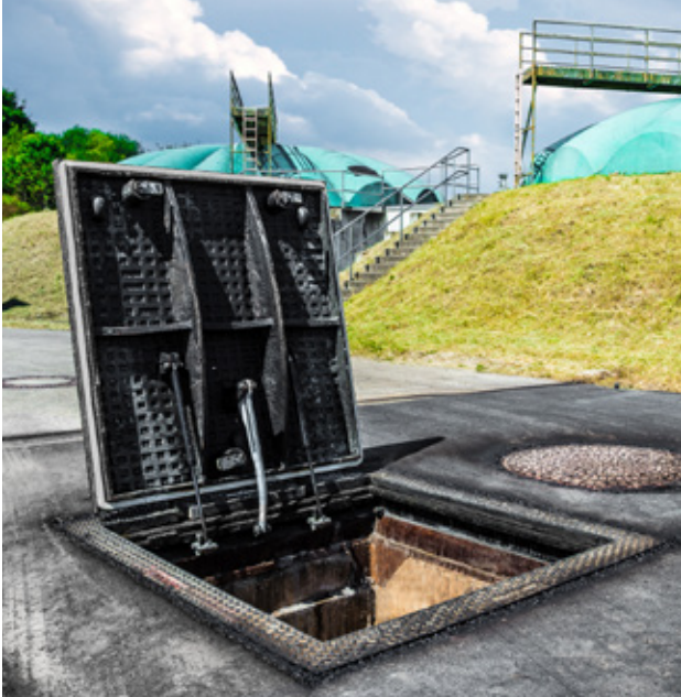
Gussabdeckung tagwasserdicht mit Öffnungshilfe, Klasse D 400, lichte Weite 1000 x 1000 mm, München
